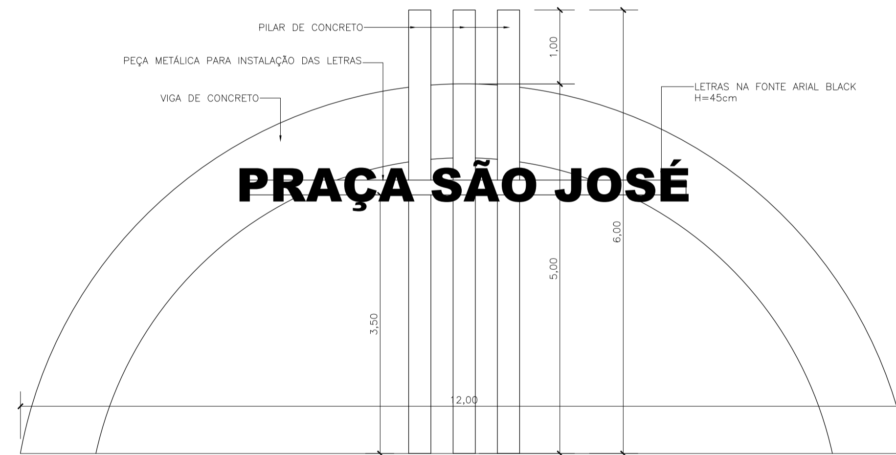
8 FACHADA FRONTAL - PORTICO ESCALA 1:50
